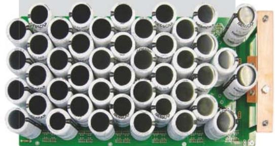
Bei Netzausfall setzen sie die gespeicherte Energie frei.
