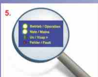
5. Zuschaltung der Versorgung. Das C-TEC wird geladen. Die LEDs „Betrieb/Operation“ und „Netz/Mains“ leuchten
