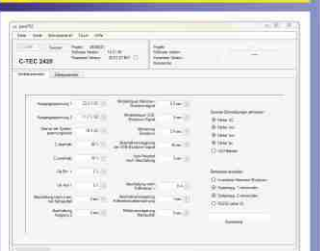
Mit der paraTEC Software können Sie Geräteparameter wie Ausgangsspannung, zulässiger Spannungsbereich, Sammelstörmeldungen usw. einstellen.
