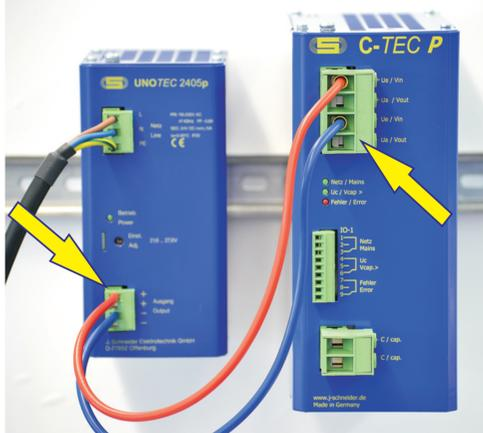
Anschluss des C-TEC P an den Ausgang des 24 V DC Netzgerätes
