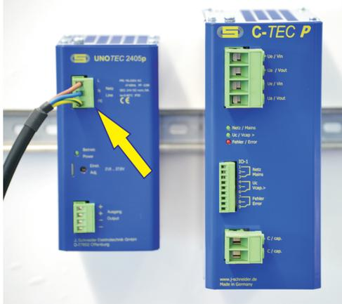
Anschluss des 24 V DC Netzgerätes an das Versorgungsnetz (230 V AC)
