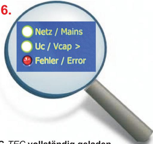
C-TEC vollständig geladen. Die LEDs „Netz/Mains“ und „U<sub>C</sub>/V<sub>cap</sub> >“ leuchten
