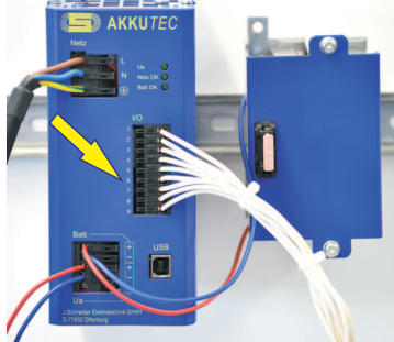
Verdrahtung der Ein-/Ausgänge (Temp. Sensor, Shutdown, Netz ok, Batt ok)
