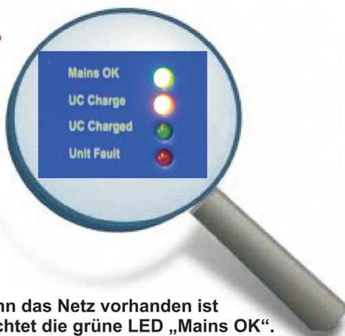
Wenn das Netz vorhanden ist leuchtet die grüne LED „Mains OK“. Die orangene LED „UC Charge“ signalisiert, dass das UCC-TEC die Module lädt. Bei einem Fehler würde die rote LED aufleuchten
