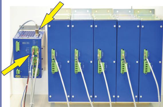
Anschluss des RS485 Buses und des Meldekontakts vom UCC-TEC an das Prozessleitsystem
