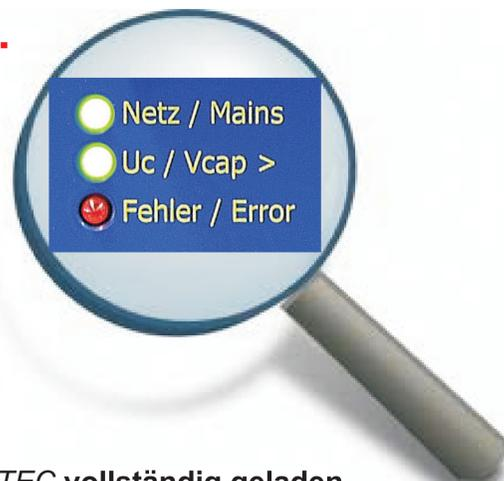
C-TEC vollständig geladen. Die LEDs „Netz/Mains“ und „ $U_c/V_{cap} >$ “ leuchten
