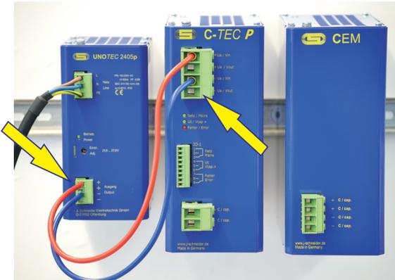
Anschluss des C-TEC P an den Ausgang des 24 V DC Netzgerätes
