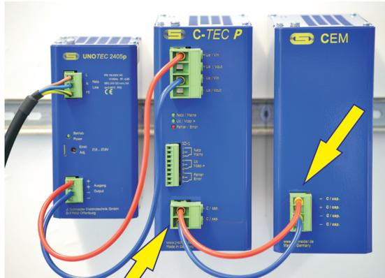
Anschluss des CEM an den Kondensatorausgang des C-TEC P
