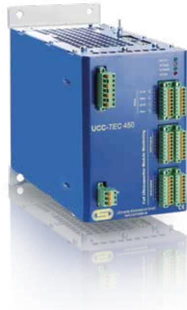
Mit der **paraTEC UCC** Software können Sie zwischen Bleibatterie-lader und Ultrakondensator-lader umschalten. Außerdem können die entsprechenden Geräteparameter wie Ausgangsspannung, zuverlässiger Spannungsbereich, Sammelstörmeldungen usw. eingestellt werden. Neben der Paramentierung kann die **paraTEC UCC** auch für die Überwachung der Anlage genutzt werden.
